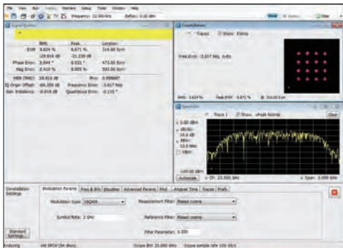
高阶调制(16QAM,符号速率2GHz,占用带宽2GHz以上,载频22.5GHz)
