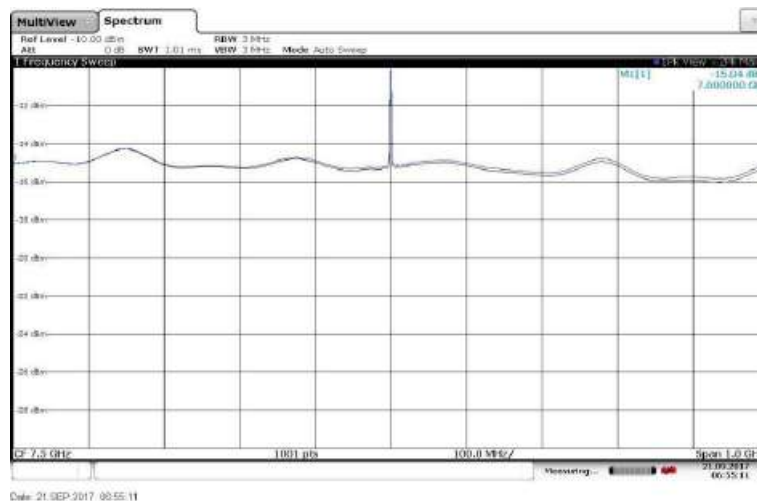
图 8 SIQM0408 频率响应测试图( LO = 7.5GHz +17dBm )
