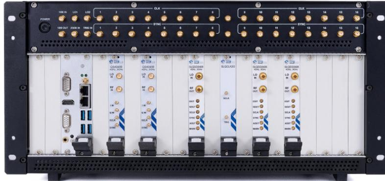
整机采用 3U 插卡结构，包含 1 个系统槽位、1 个时钟槽位和 16 个外设槽位，总宽度 440mm，总高度 177mm（4U 高度）。可以独立运行工作，也支持多台之间同步输出。
