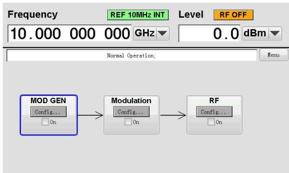
通过旋转旋钮和按下按键,用户可以在图形化界面和对话框进行切换,能够实现单手控制仪器。在图形化功能界面或对话框中的光标是逐行移动的。图形化界面中的每个板块如果被激活,那么板块的背景会变成高亮的彩色背景。
