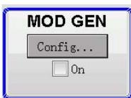
**调制产生板块** 内部调制源通过该板块进行配置。一个内部的脉冲发生器可以用作脉冲调制源。内部产生的脉冲信号可以通过仪器前面板的PULSE OUT输出。脉冲信号的脉宽和周期在这个板块中进行配置。板块的显示状态指示了调制产生源是否工作,当开启了该功能后,板块颜色会变为蓝色,并且状态开会被勾选。
