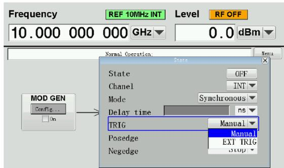
外部扫频触发：在扫频模式里选择外部触发方式，系统默认每接收到一个外部触发的上升沿按照频率步进跳频一次，外部触发输入对应此功能使能。
