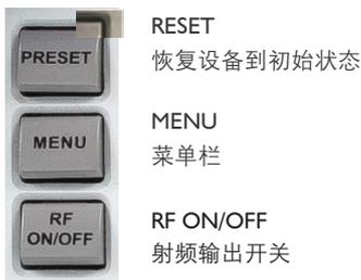
1、初始状态输出频率10GHz,输出功率0dBm,射频输出关闭,调制信号产生关闭,调制关闭,所有的通讯接口关闭。
